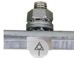
Die Schraube für den Potentialausgleich befindet sich an der Rückseite der Maschine im Bereich der Medienanschlüsse.
