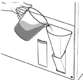
3. Chemie mit Hilfe eines Trichters vorsichtig in den Behälter füllen, bis der Behälter voll ist. Füllstand prüfen.
