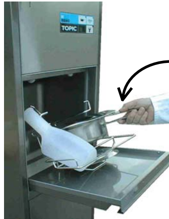
2. Reinigungsgut in der vorgesehenen Position im Gefäßhalter einsetzen.
